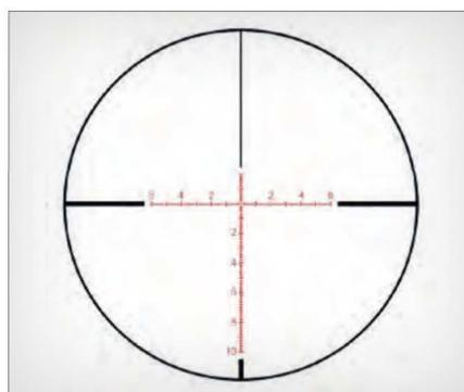
▲ Il reticolo - denominato Mhr, acronimo di Mil Hunting Reticle - è posizionato sul primo piano focale, ovvero varia la sua dimensione al variare degli ingrandimenti, ed è dotato di una serie di riferimenti sull'asse verticale ed orizzontale che offrono la possibilità di stimare la distanza oltre che non mutare il punto di impatto al variare degli ingrandimenti
